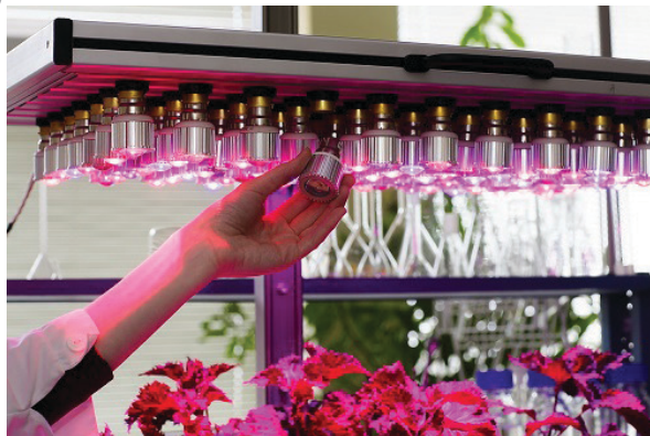
9 pav. UAB „Hortiled“ ir UAB „Energenas“ sukurta išmanioji kietakūnio apšvietimo sistema
