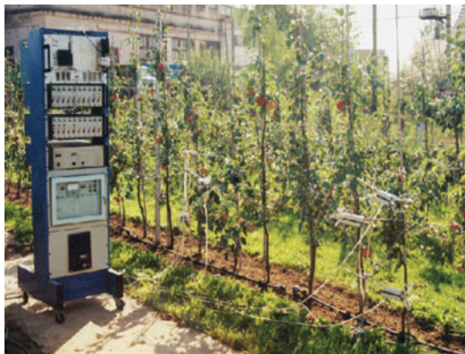
2 pav. Fotosintezės ir kitų augalų fiziologinių parametru monitoringas in vivo „Ekoplant“ sistema
