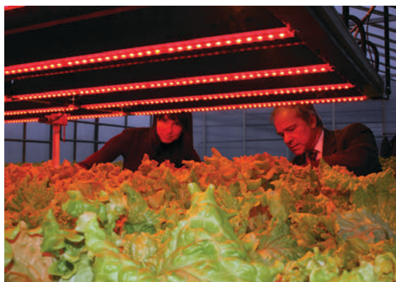
10 pav. Patentuotos technologijos kietakūnio apšvietimo modulis. LAMMC SDI augalų fiziologijos laboratorijos darbuotojai išbando jį gamybinio šiltnamio sąlygomis
